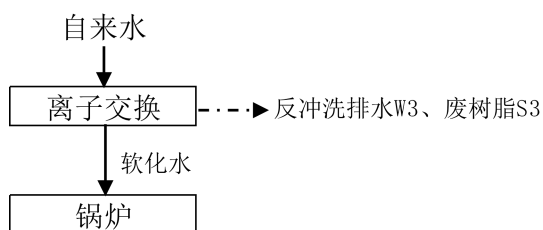
图 6.1-5 软水制备工艺流程及产污节点图
