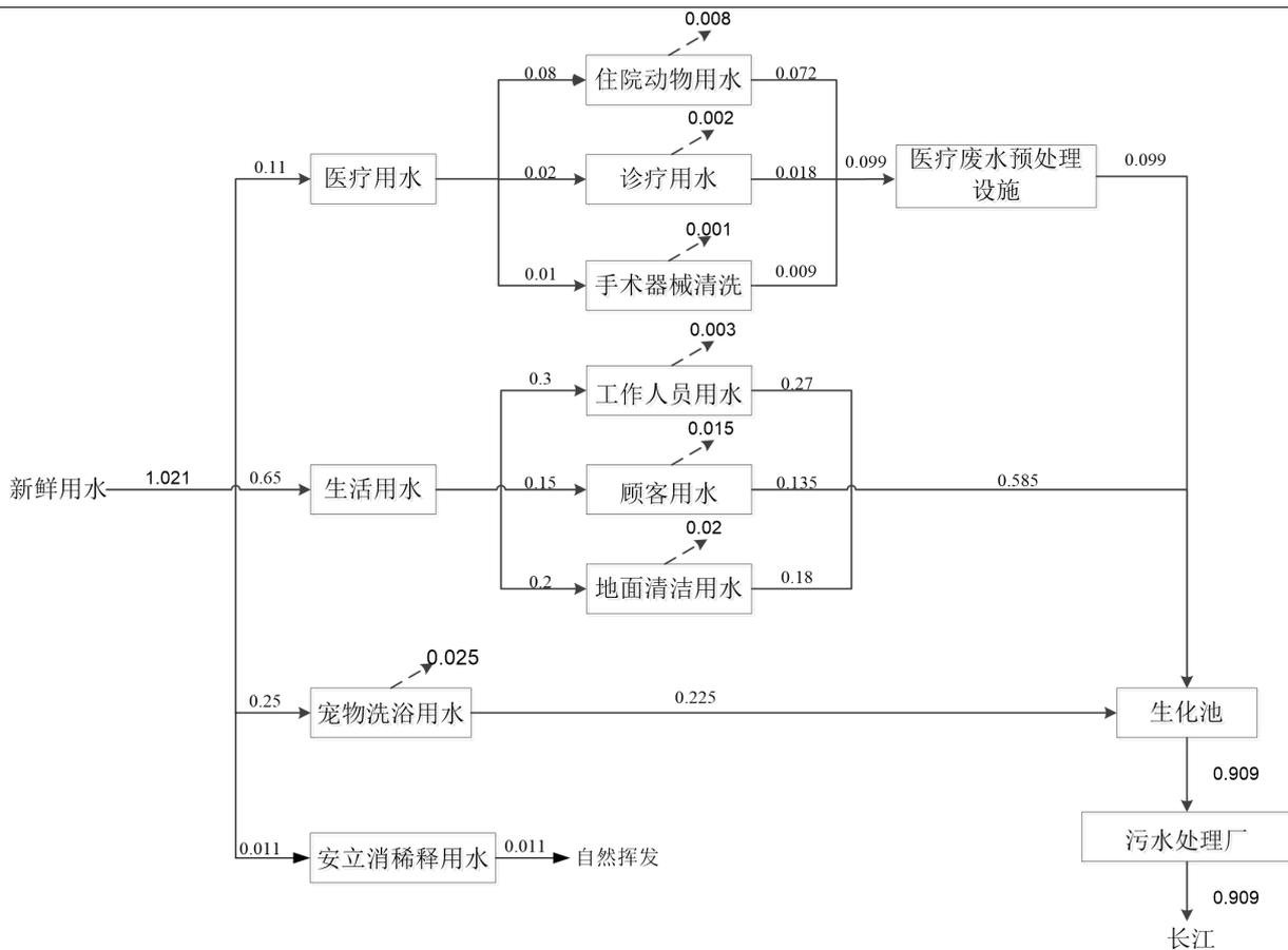
图 2-1 项目水平衡图 (单位: m<sup>3</sup>/d)
